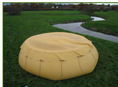
Il est nécessaire de régler la tension sur les cordelettes puisque le niveau de l'eau de la citerne varie au cours de l'opération de remplissage/vidage.
