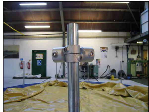
5. Befestigen Sie alle Rahmenständer mit den unteren horizontalen Stangen an der Basis des Rahmenständers. Wir empfehlen, dass die horizontalen Stangen sollten ca. 120mm über dem Boden
