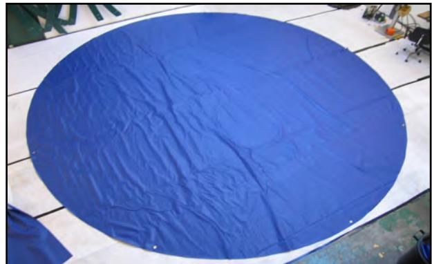
3. Coloque el tanque de contención rápida. Asegúrese de que la base está plana y en su posición final.
