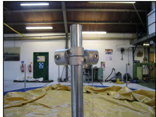
5. Conectar todas las patas entre sí con los postes horizontales inferiores en la base de la pata. se recomienda que los postes horizontales debe ser de aproximadamente 120 mm sobre el nivel del suelo.
