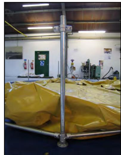
6. Zur Anpassung des Drehventils kann die horizontale Stange im Bereich des Kugelhahns angehoben werden.
