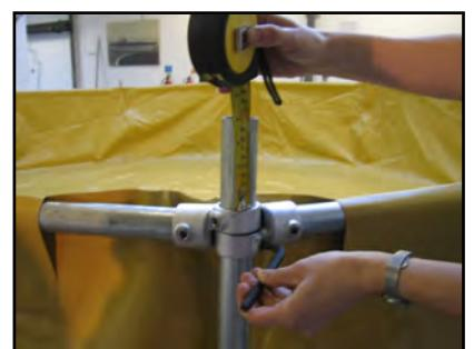
Stellen Sie sicher, dass die oberen drehbaren Gerüstkupplungen in der richtigen Höhe und im richtigen Winkel eingestellt sind. Die richtige Höhe ist 100mm von oben, wie oben dargestellt. Der richtige Winkel wird mit bloßem Auge eingestellt, indem der Rand der Tankauskleidung als Anhaltspunkt genommen wird.
